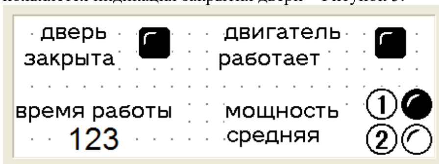
Рис.5 - Экран начальных установок при срабатывании датчика закрытия двери и работающем двигателе.
